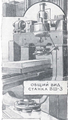
ОБРАБОТКА ПЛОСКОСТИ ПЛИТЫ НА СТАНКЕ ВШ-3
